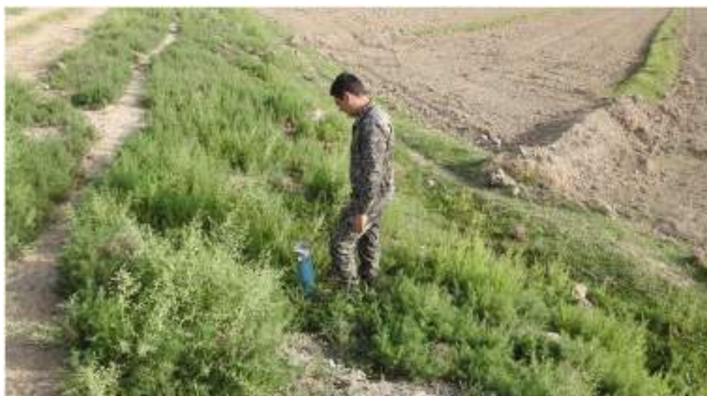
Иллюстрация 9-3 Отбор проб грунтовых вод из существующей трубки пьезометра
