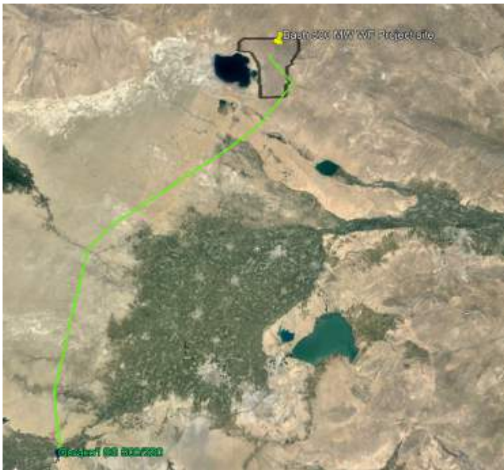
Рисунок 2-3 Прохождение 162 км ВЛЭП от Ветряной электростанции Баш до подстанции Каракуль
